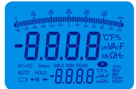
Die große doppelte LCD-Digitalanzeige mit blauer Hintergrundbeleuchtung und ein Bargraph mit 61+2 Segmenten sorgen für optimale Ablesbarkeit. Die zentrale Null im Bargraph stellt Signalveränderungen deutlich dar — eine große Hilfe bei Einstellarbeiten.
